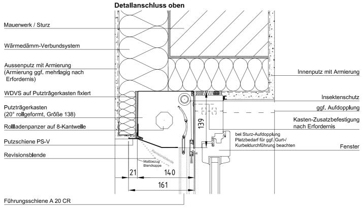
Der Putzträger-Kasten darf sich nicht bewegen und ist zusätzlich zu befestigen. Platzbedarf für ggf. überstehenden Wetterschenkel am unteren Fensteranschluss beachten.
